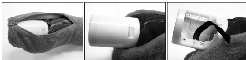
Batteriefach mit Batterie-Bändchen
